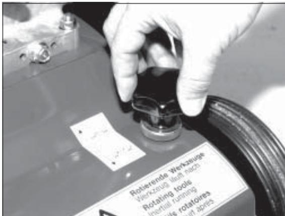
3) On règle la profondeur de verticutage en tournant la vis de réglage.
