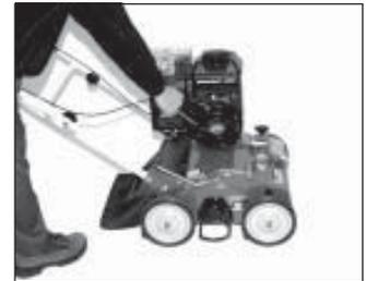
4) Tirer le câble du démarreur. Veillez à être derrière le guidon et en dehors de la zone de danger.
