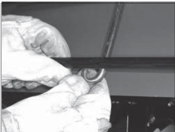
7) Tourner le crochet sur le côté.
