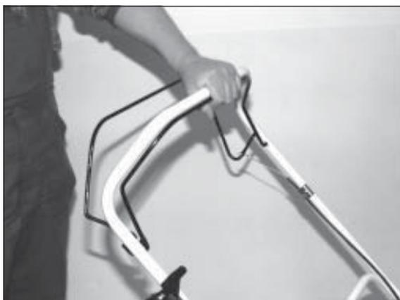
1) Quand on tire sur l'étrier de sécurité et qu'on appuie ensuite sur l'étrier de commande, l'entraînement des couteaux est mis en marche.
