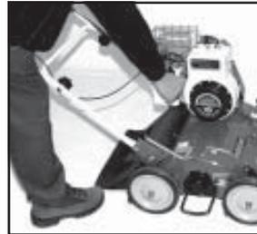
3) Tirer le câble du démarreur. Veillez à être derrière le guidon et en dehors de la zone de danger.
