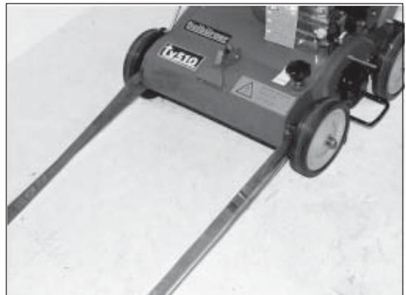
4) Les axes avant et arrière servent de points de fixation. Pose de la courroie à l'avant.
