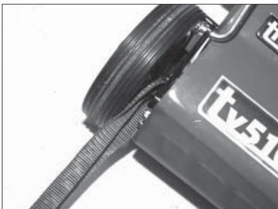
5) Pose de la courroie à l'avant. Utilisez en tout cas les deux points de fixation.
