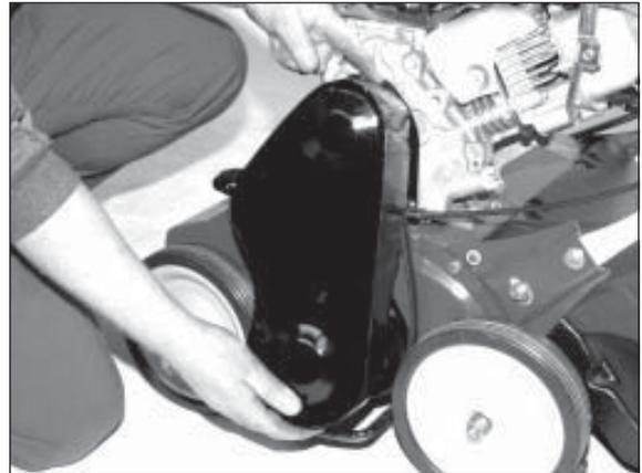
2) Retirer la protection de courroie trapézoïdale.
