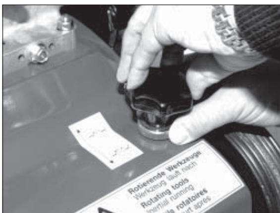
5) Rebloquer le contre-écrou en maintenant la vis de réglage.
