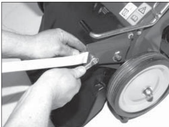
1) La hauteur du guidon est réglable via un trou oblong dans la paroi du carter. Desserrer les vis de la jonction de guidon. Procéder de la même façon pour le côté opposé.
