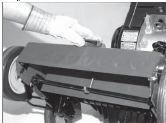
4) Abaisser maintenant le verrouillage jusqu'à ce que le dispositif de blocage ait pris.
