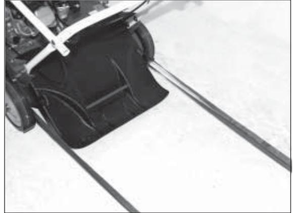
2) Transport avec un véhicule : fixez l'appareil avec des courroies. Les essieux avant et arrière servent de points de fixation.
