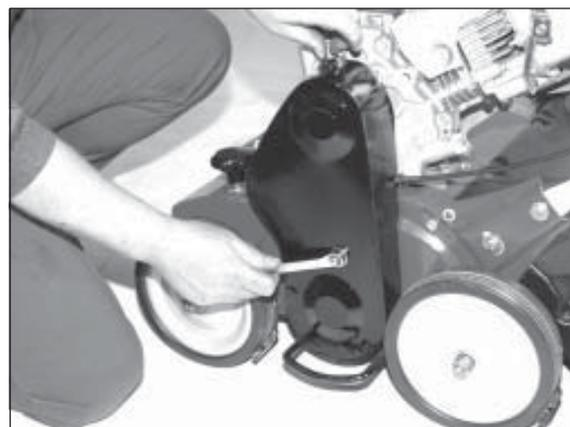
6) Pour finir, mettre en place et bloquer la protection de courroie trapézoïdale.
