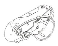
Dévisser l'écrou du galet supérieur et sortir ce dernier, si nécessaire démonter le galet inférieur
