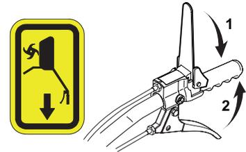
**⚠ Ne pas actionner ces commandes lors de la mise en route du moteur.**
