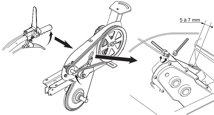
**d. Câbles de marche arrière : réglage de la tension**
