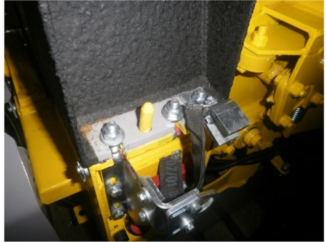
Ensuite, il est possible de rabattre le capot d'éjection vers le haut. A cet effet, orienter puis verrouiller la tuyère d'éjection dans la direction opposée (voir photo) afin de diminuer la force nécessaire à rabattre le capot.
