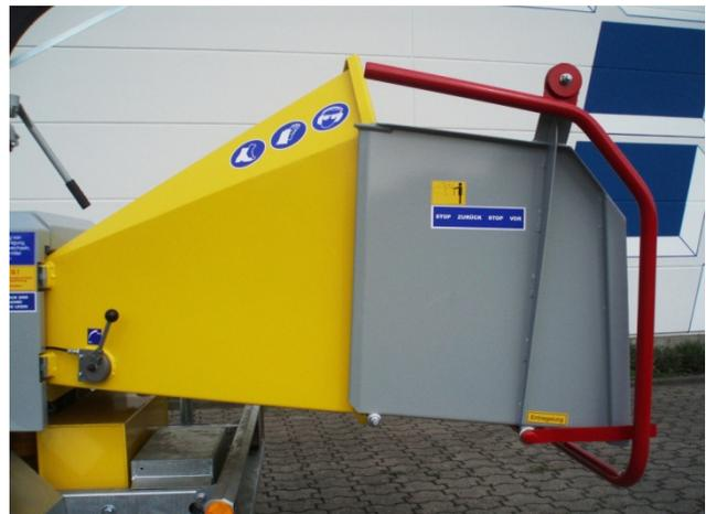
La tuyère d'éjection est orientable et verrouillable sur presque chaque position. Veiller à ce que les copeaux ne soient pas éjectés dans la zone d'utilisation de la machine.
