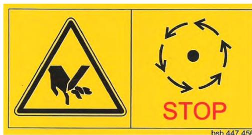
Maintenir une distance suffisante avec les pièces de la machine en rotation !
