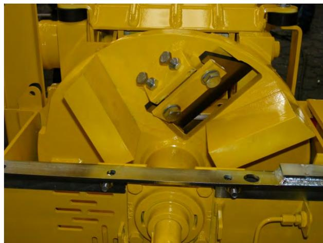
Les cylindres d'introduction sont entraînés par les moteurs hydrauliques et peuvent être commandés avec le levier de commande dans leur sens de rotation (avance, arrêt, recul, arrêt de sécurité) (cf. autocollant sur le côté de la trémie).
