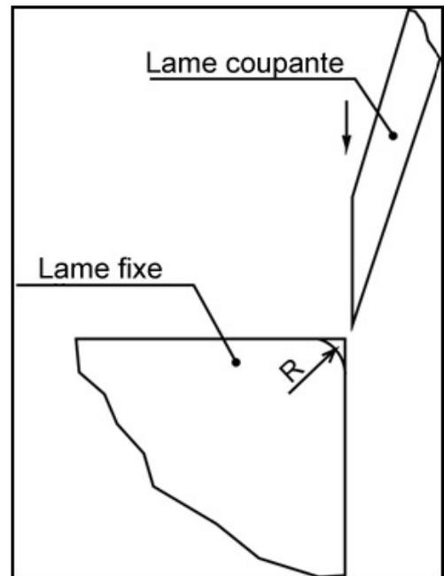
Pour dégager la lame fixe, le support doit être desserré sur le côté du boîtier. La lame fixe se trouve derrière celui-ci, elle peut être retournée ou échangée.
