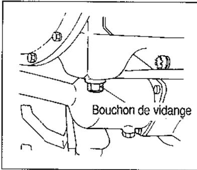
Enlever le bouchon de vidange situé en bas du carter d'huile et laisser s'écouler l'huile usagée. Remettre le bouchon de vidange, et regarnir d'huile neuve (3,1 litres).
