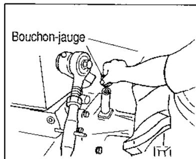
Le bouchon-jauge est situé du côté droit de l'essieu arrière. Oter la jauge et essuyer l'extrémité, la remettre en place et la tirer à nouveau pour vérifier le niveau d'huile qui doit se situer entre les limites supérieure et inférieure gravées sur la jauge.
