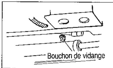
Enlever le bouchon de vidange situé sous le carter et laisser s'écouler l'huile usagée. Remettre le bouchon de vidange en place.
