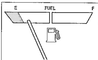
Indique le niveau de carburant lorsque la clé de contact est en position MARCHE.
