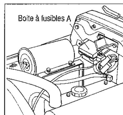
Elle contient 11 fusibles. Remplacer un fusible grillé par un autre de même ampérage, sous peine de dommages aux appareils électriques concernés
