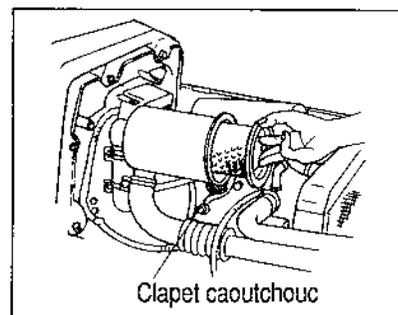
Ouvrir le capot et déposer la joue latérale droite. Faire sortir les poussières accumulées à l'intérieur du clapet en caoutchouc en pinçant celui-ci entre les doigts. En cas de dépôts humides, nettoyer avec un chiffon.
