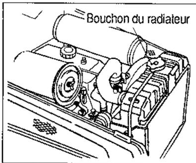
Oter le bouchon du radiateur et vérifier que le niveau du liquide de refroidissement atteint le col de la goulotte de remplissage. Lorsque le niveau est insuffisant, le compléter en ajoutant de l'eau. La coloration du liquide indique qu'il contient de l'antigel.
