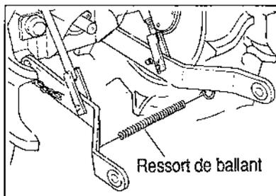
Lorsque l'attelage est libre, contrer le ballant des brancards à l'aide du ressort de ballant pour que ces derniers ne puissent heurter les roues arrière. Lorsqu'un équipement est attelé au tracteur, fixer le ressort aux étriers situés sur la partie inférieure du brancard gauche. Ces étriers peuvent également servir de support aux goupilles de brancard lorsque celles-ci ne sont pas utilisées.
