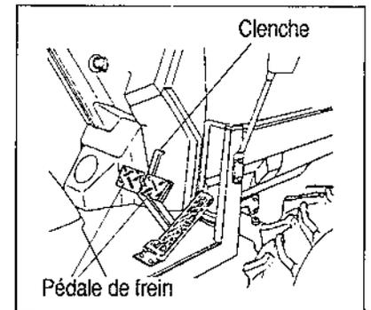
Les pédales de frein permettent de contrôler le freinage des roues arrière indépendamment l'une de l'autre. Lorsque la pédale de droite est enfoncée, la roue arrière droite est freinée. Lorsque la pédale de gauche est enfoncée, la roue arrière gauche est freinée.
