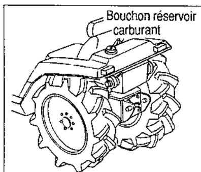
En règle générale, faire le plein du réservoir avant de commencer à travailler. Tourner la clé de contact sur ON "MARCHE" pour vérifier le niveau sur la jauge du tableau de bord, et compléter le niveau si nécessaire. Le bouchon de réservoir se situe derrière le siège conducteur.
