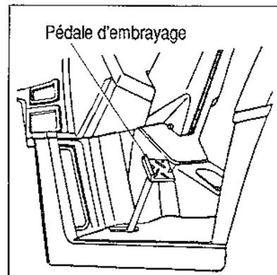
Pour débrayer, enfoncer la pédale à fond. Placer le levier principal de changement de vitesse à la position désirée, et relâcher doucement la pédale pour embrayer. La règle générale est d'enfoncer la pédale rapidement et de la relâcher doucement.
