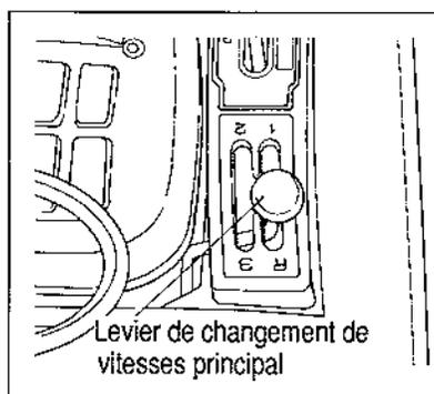
L'utilisation de ce levier, combinée à celle du relais sélecteur de vitesses, permet de sélectionner 6 vitesses avant et 2 vitesses arrière.
