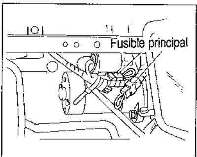
L'ensemble du faisceau électrique est protégé par deux fusibles principaux, en forme de pontage, et montés directement sur le circuit électrique. Si l'un des deux est grillé, aucun appareil électrique ne peut fonctionner. Toujours localiser et réparer la cause de la panne avant de remplacer
