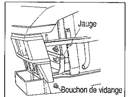
Oter la jauge et essuyer l'extrémité. La remettre en place et la tirer à nouveau pour vérifier le niveau d'huile qui doit se situer entre les limites supérieure et inférieure de la jauge. Compléter le niveau s'il est insuffisant, en utilisant la même huile que celle se trouvant déjà dans le carter de direction.
