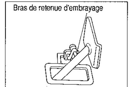
Pendant une immobilisation de longue durée, hivernage par exemple, maintenir la pédale d'embrayage enfoncée en la crochétant à l'aide du bras de retenue, afin d'éviter d'endommager le mécanisme d'embrayage.
