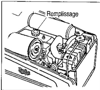
Utiliser une huile dont la viscosité correspond à la température d'utilisation. Le tracteur est livré d'origine avec de l'huile SAE 10W/30.
