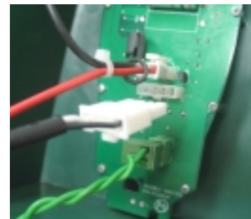
Figure 1.20 - Connexion du cordon d'alimentation
