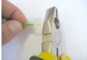
Figure 1.17 - Dénudez 6mm d'isolation à l'extrémité du fil
