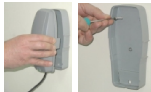
Montage du commutateur de périmètre avec les trois bosses de montage au dos
