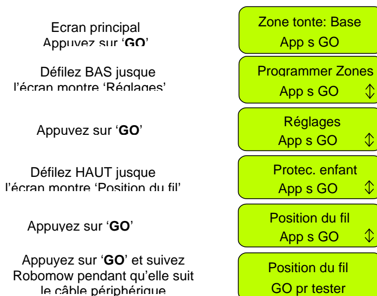
Figure 1.44 Essai de position du câble périphérique
