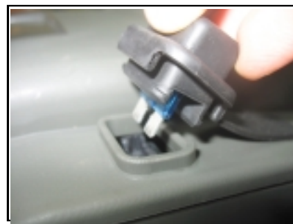
Figure 1.27 - Introduction du fusible des batteries
