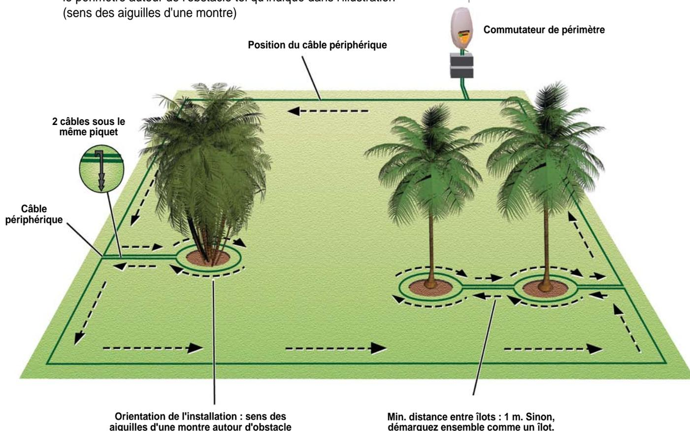
**Précaution !** Installer le câble périphérique dans le sens inverse des aiguilles d'une montre (sens anti-horaire) autour de l'obstacle provoquera le passage de la Robomow dans l'îlot.
