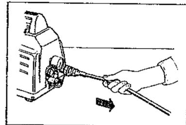
Ne pas écraser ou endommager le câble électrique et ne pas effectuer de réparations précaires sur le câble.
