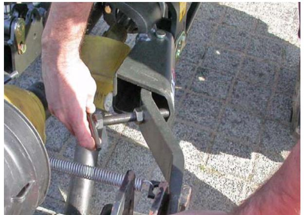
7.3 Ajuster le contre écrou pour garantir le blocage.
