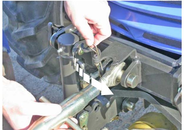
**8.4** Desserrer les vis de réglage des bras afin de pouvoir dételer l'outil.
