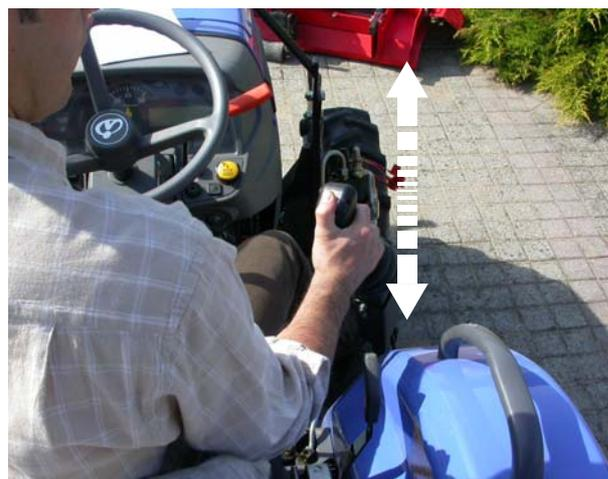
**12.2.2** Commande de la ligne hydraulique auxiliaire (suivant équipement). Actionner le manipulateur MX vers la droite et la gauche.
