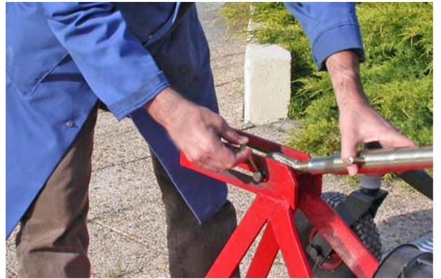
**8.3** Retirer la goupille de blocage. Relever la barre de 3ème point et fermer le crochet. Remettre la goupille de blocage.
