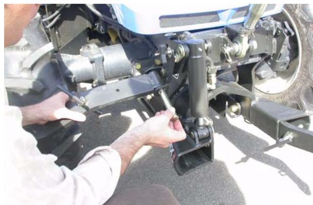
**9.6** Desserrer et retirer l'écrou papillon du support et positionner verticalement le bras sur le support. Maintenir le bras et procéder au serrage à l'aide de l'écrou papillon.
