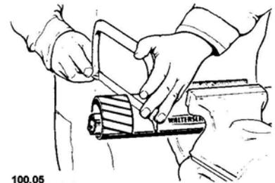
Arrondir les arêtes, enlever soigneusement les copeaux. Graisser le joint coulissant.
