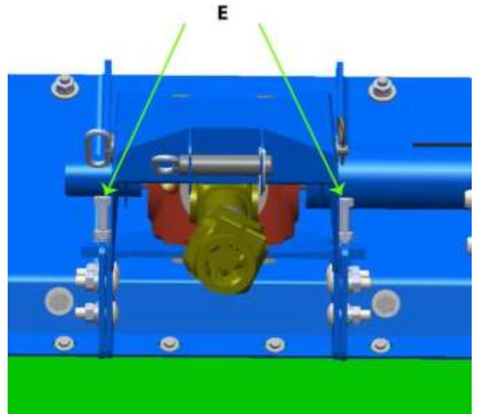
**Important :** le réglage équivalent de (D) et (E) permet de garder l'axe de transmission parallèle à l'axe du rotor.
