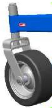
Abaisser le relevage de la tondeuse jusqu'au contact de l'élément d'appui arrière au sol. S'assurer que le dessus de la machine soit bien horizontal. Corriger la hauteur des roues si nécessaires.
