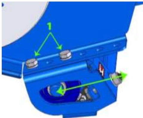
Abaisser le relevage de la tondeuse jusqu'au contact de l'élément d'appui arrière au sol. S'assurer que le dessus de la machine soit bien horizontal. Corriger la hauteur des roues. Pour cela
