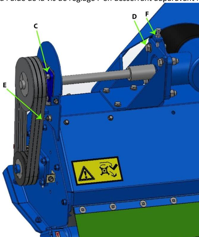
**Important : le réglage équivalent de (E) et (F) permet de garder l'axe de transmission parallèle à l'axe du rotor.**
