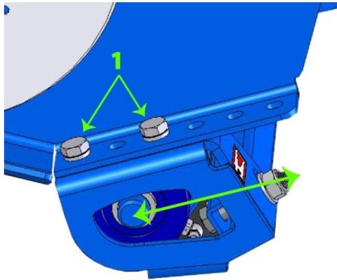
Abaisser le relevage du tracteur jusqu'au contact de l'élément d'appui arrière au sol. S'assurer que le dessus de la machine soit bien horizontal. Corriger si besoin avec le 3<sup>ème</sup> point.
