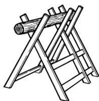
Les objets en bois non fixes doivent être immobilisés de façon sûre, de préférence sur un chevalet. Le bois ne doit pas être maintenu par le pied ni par une autre personne. Les bois ronds doivent être bloqués pour ne pas bouger pendant la coupe.
