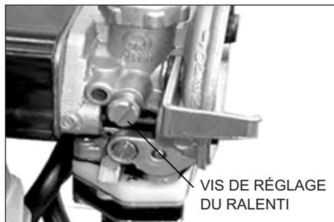
1. Poser l'appareil sur le sol, puis démarrer le moteur et le laisser tourner au ralenti pendant 2 à 3 minutes jusqu'à ce qu'il soit chaud.
