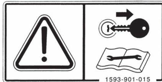
*Couper le moteur et retirer la clé de contact avant de procéder à l'entretien ou à faire une réparation.*
