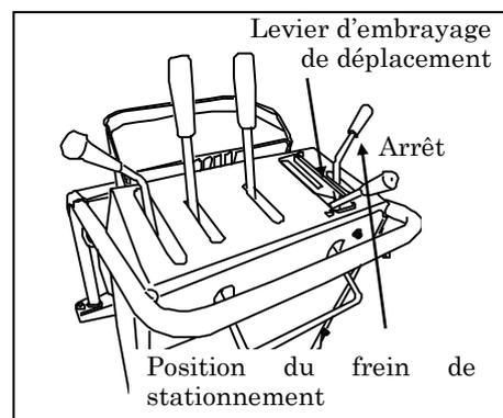
(3) Le levier de frein permet d'agir sur la vitesse de déplacement de la machine. Ne tirez pas trop fort sur le levier de frein en descente. La machine risquerait de se renverser.
