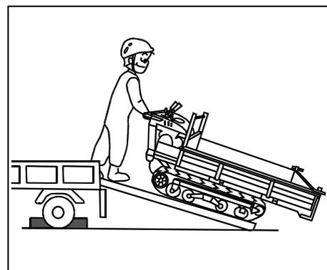
(4) Lors du transport de la machine par camion, placez le levier d'embrayage de déplacement en position [Stationnement], placez des cales (cale-roue) sous la machine et fixez-la à l'aide de cordes. Évitez les départs, les demi-tours brusques et les manœuvres soudaines pendant le transport. Tout mouvement de la machine risque de provoquer une situation dangereuse.
