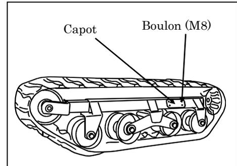
(2) Le capot du châssis de la chenille renferme un boulon de tension. Réglez le boulon de tension après avoir desserré l'écrou de verrouillage.
