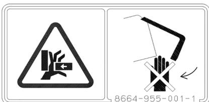
Manténgase alejado del bastidor trasero del contenedor mientras cierra la puerta trasera.
