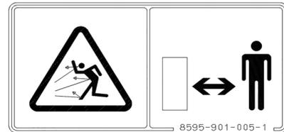
Manténgase alejado de la abertura de descarga de la plataforma de corte, ya que las piedras u otros objetos duros expulsados por la segadora pueden golpearle.
