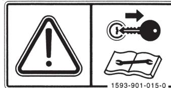
Apague el motor y quite la llave del interruptor de motor de arranque antes de hacer el mantenimiento o reparación.
