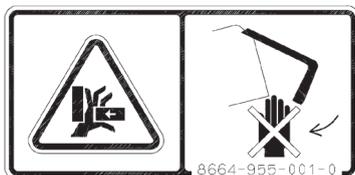
Manténgase alejado del bastidor trasero de contenedor mientras se cierra la puerta trasera.
