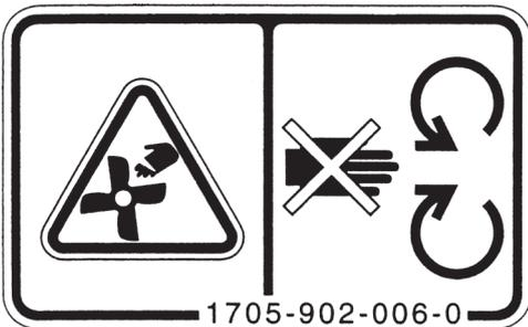
*Manténgase alejado del ventilador en movimiento.*
