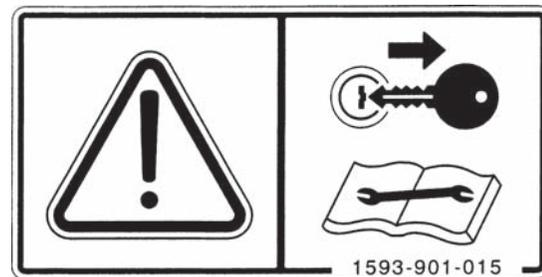
Coupez le moteur et retirez la clé de contact avant de procéder à l'entretien ou à la réparation du tracteur.
