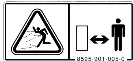
Manténgase alejado de la apertura de descarga de la cubierta de cortacésped, ya que las piedras u otros objetos duros proyectados por el cortacésped podrían herirle.
