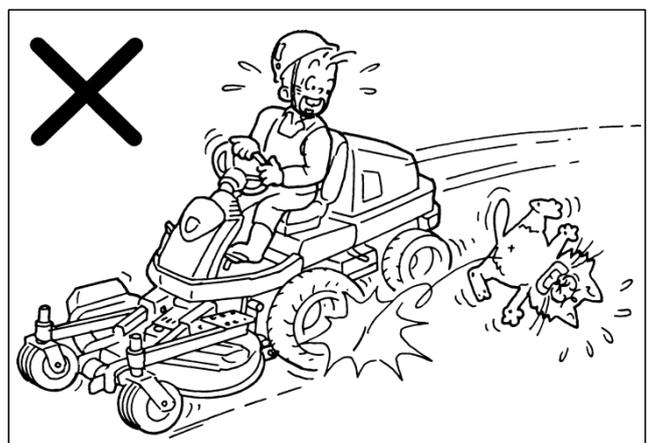
3.4. Nunca opere el cortacésped frontal en terrenos con zanjas, agujeros o escalones que puedan colapsar. En estos sitios el cortacésped frontal puede volcar o caer.
