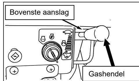
2. Draai de contactsleutel in de stand
