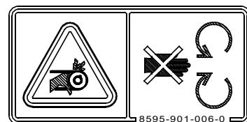
Keine rotierenden Teile berühren, während die Maschine in Betrieb ist. Verletzungsgefahr!
