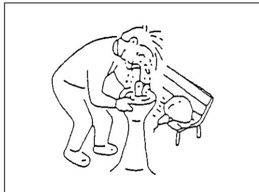
4. Vul voldoende accuvloeistof bij. Als de accu continu wordt gebruikt (gevuld) met het vloeistofpeil onder de laagste limiet, verslechteren diverse delen van de accu snel en kan de accu voortijdig defect raken of barsten (exploderen), waardoor er een zeer gevaarlijke situatie ontstaat.
