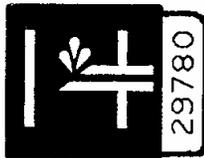
(3) AMORÇAGE (le moteur) : A utiliser pour un démarrage à froid du moteur. Lisez et suivez les instructions d'utilisation et d'entretien du moteur. Appuyez sur la pompe d'amorçage pour amorcer le moteur.
