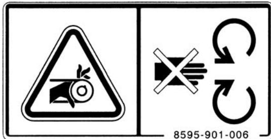
*No quite las cubiertas de seguridad con el motor en marcha.*
