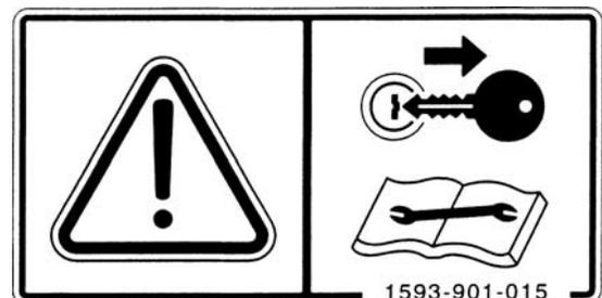
*Apague el motor y quite la llave de motor de arranque antes de hacer el mantenimiento o reparación.*
