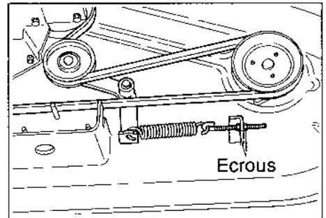
2. Dégager la courroie usée des poulies et placer la courroie neuve.
