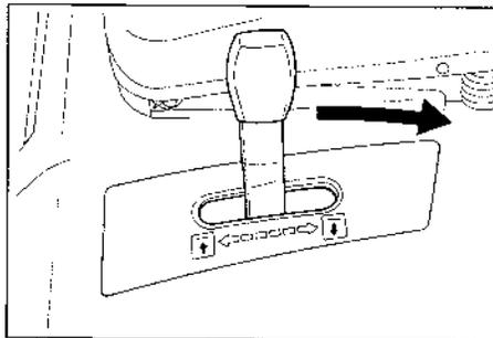
Basculer le levier de relevage vers l'arrière c'est à dire sur la position haute.
