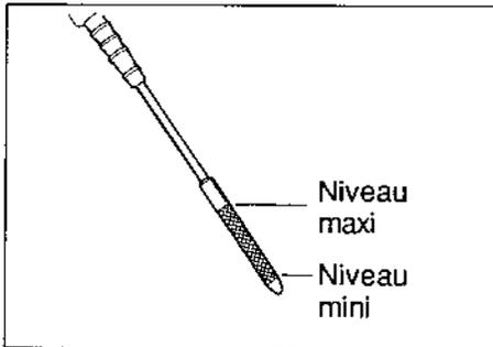
Sortir la jauge d'huile et l'essuyer. La remettre dans son logement et la retirer pour contrôler le niveau d'huile qui doit être compris entre la limite inférieure et supérieure.
