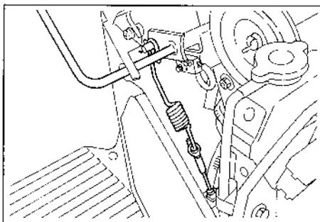
3. Si le ressort ne s'étire pas correctement, régler le câble d'embrayage.
