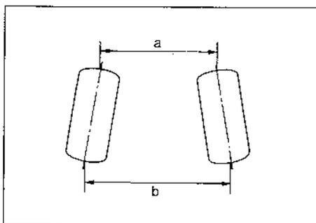
La tolérance de carrossage (b - a) doit être de 2-4 mm.
