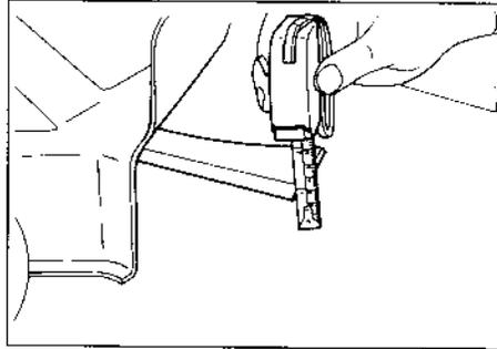
Si la tondeuse est légèrement de travers par rapport à l'axe du tracteur, ajuster sa position en réglant la fixation des tirants du berceau support.
