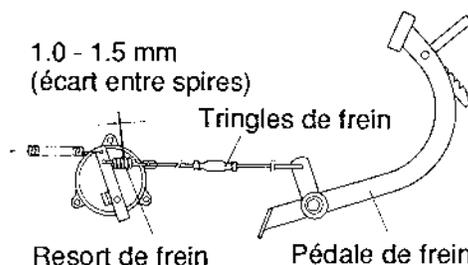
Appuyer sur la pédale de frein jusqu'en butée. Vérifier si le ressort de frein est correctement tendu. Dans la négative, ajuster la longueur de la tringle de frein à l'aide du tendeur jusqu'à ce que l'écart entre spires soit compris entre 1,0 et 1,5mm.
