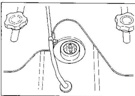
Basculer le siège pour contrôler la jauge à carburant.
