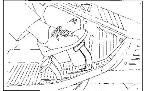
Le frein de parking est conçu pour se désenclencher automatiquement lorsque l'on appuie sur cette pédale. Vérifier que le frein de parking est bien débloqué.
