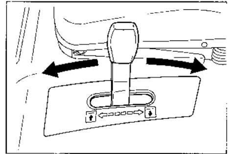
Ce levier commande la descente et le relevage de la tondeuse.
