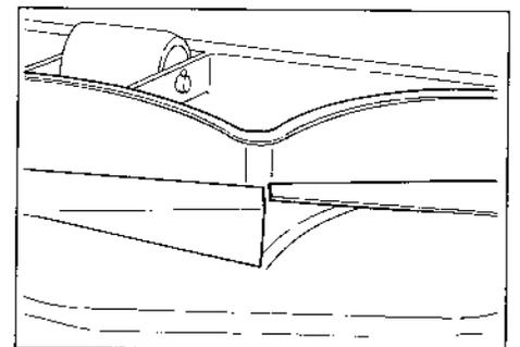
5. Installer une rondelle d'appui sur chaque couteau et bloquer chaque écrou.
