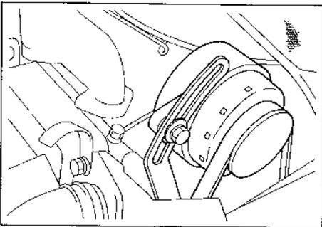
b. Positionner l'alternateur pour obtenir une tension correcte de la courroie. Resserrer le boulon.
