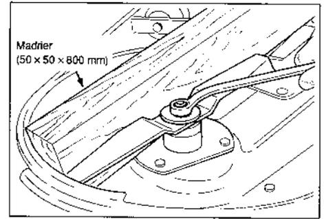
3. Retirer les couteaux usés et les remplacer par des neufs.
