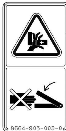
Manténgase alejado del bastidor del colector mientras se vierte el contenido.
