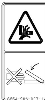
Manténgase alejado de la plataforma de corte mientras ajusta la altura de la segadora.
