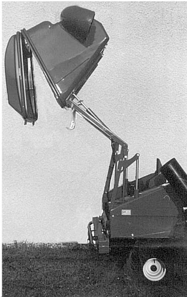
figure 29 Bennage en hauteur
