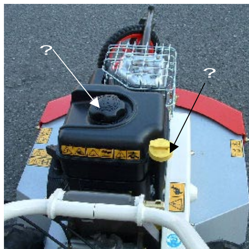
1 : Bouchon de réservoir 2 : Bouchon-jauge
