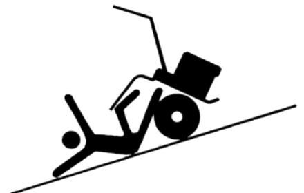
En caso de operar en el campo con muchas piedras y terreno duro, la máquina puede moverse en direcciones inesperadas y volcar. Puede quedar atrapado en la máquina. Ajuste la profundidad del labrado según las condiciones del terreno.
