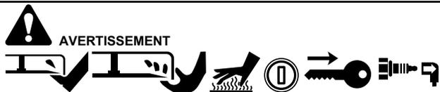
NE PAS essayer d'effectuer des réglages, de la maintenance, des interventions ou des réparations quand le moteur tourne.
