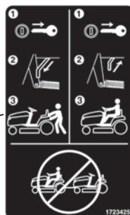
Étiquette - Débrayage de la transmission (1723425)
