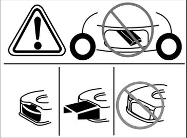
Risque de blessures – Ne travaillez qu'avec l'orifice d'éjection en place.
