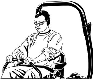
Maintenez l'arceau de sécurité en position relevée et attachez la ceinture de sécurité. Il n'y a aucune protection anti-renversement quand l'arceau de sécurité est abaissé! Ne pas sauter de la tondeuse si elle se renverse (il est plus sûr de rester attaché(e) par la ceinture de sécurité, l'arceau de sécurité étant relevé)
