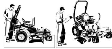
Toujours débrayer tous les entraînements, couper le moteur et retirer la clé avant de procéder au nettoyage, au plein de carburant ou à une intervention.
