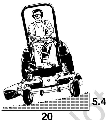
L'utilisation de la machine sur des pentes raides peut être dangereuse. L'utilisation de la machine sur une pente trop raide alors que la traction (et le contrôle) des roues laisse à désirer peut entraîner la glissade de la machine, la perte de sa manœuvrabilité et de son contrôle, voire même son retournement. Vous ne devez pas utiliser la machine sur des plans inclinés ayant une pente supérieure à une élévation de 5,4 pieds sur une longueur de 20 pieds (15 degrés).
