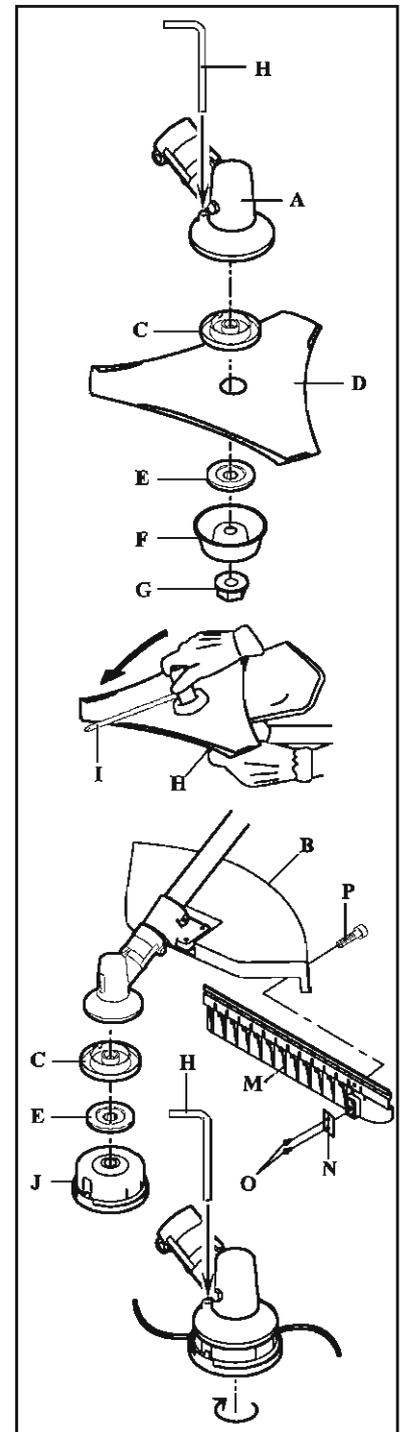
**E ● Instalación de la herramienta de corte**
