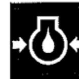
S'allume en cas de diminution excessive de la pression d'huile du moteur. Le témoin doit s'éteindre quelques secondes après le démarrage du moteur.
