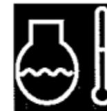
S'allume si la température du liquide de refroidissement est trop élevée.
