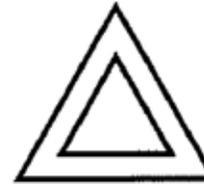
Appuyez pour actionner les feux de détresse. S'allume dans l'interrupteur et, s'il est monté sur le tableau de bord, s'allume avec les feux extérieurs.
