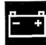
S'allume si le circuit de charge de la batterie tombe en panne pendant que le moteur tourne. Le voyant doit s'éteindre quelques secondes après que le moteur commence à tourner.
