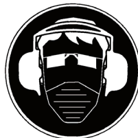
Portez un masque anti-poussière, un casque antibruit et des lunettes de protection
