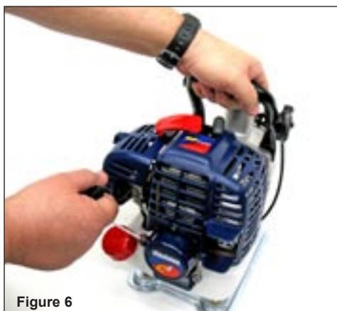
4. Tout en tenant fermement la poignée de la pompe de la main gauche, de la main droite, tirer lentement sur la poignée du lanceur à rappel jusqu'à ce qu'une résistance se fasse ressentir, puis tirer rapidement pour démarrer le moteur.
