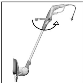
**4. Réglage pour la coupe des bordures** (illustration 11): Régler la longueur du tube au minimum ou au maximum, comme décrit au point 2. Dans cette position, toute la partie supérieure de la poignée peut être tournée à 180°. La longueur du manche peut ainsi être réglée dans 5 positions différentes.
