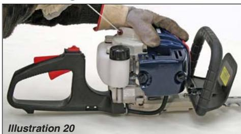
1. Poser l'appareil sur le sol. Tenir le couvercle du moteur de la main gauche et la poignée de lanceur de la main droite.
