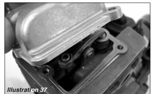
7. Reposer le joint du cache-culbuteur afin de garantir une étanchéité parfaite, puis remonter le cache-culbuteur.
