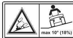
Ne pas rouler sur des pentes de plus de 10° (18 %) d'inclinaison !
