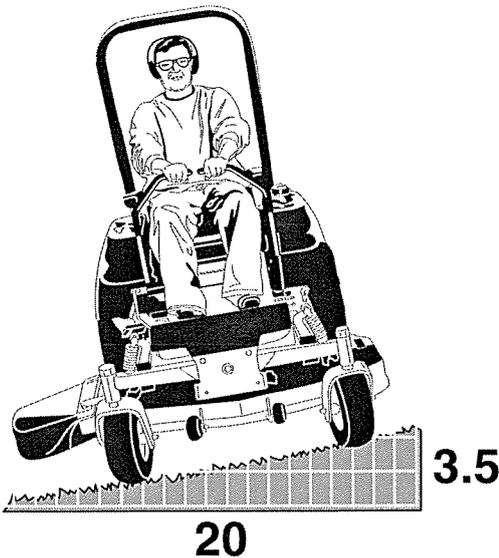
Le fonctionnement sur des pentes peut être dangereux. L'utilisation de l'unité sur une pente trop raide où une traction de roues inadéquate (et un contrôle) peut entraîner glissement, perte de direction, perte de contrôle et éventuel renversement. Ne pas utiliser la machine sur une pente supérieure à une élévation de 1 m (3,5 pieds) sur une longueur de 6 m (20 pieds) (10 degrés).
