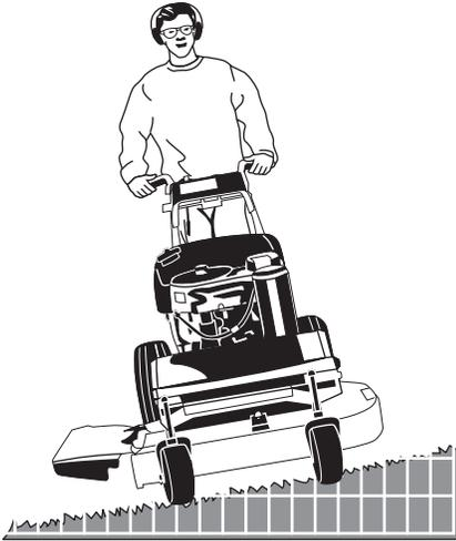
L'utilisation de cette machine sur une pente trop forte peut causer des blessures graves. Si la machine est utilisée sur une pente telle que l'adhérence (et la maîtrise) de la machine et le contact des pieds au sol sont insuffisants, l'opérateur peut perdre le contrôle, voir glisser et chuter ou faire culbuter la tondeuse.
