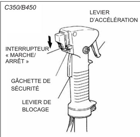
(a) Déplacer l'interrupteur « MARCHÉ/ARRÊT » en position « I ».
