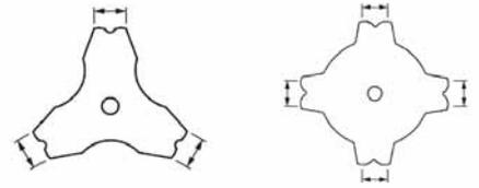
L'angle d'affûtage doit être d'environ 45°. ne pas trop affûter les extrémités de la lame. Laisser 0,2 à 0,5 mm d'espace non affûté.
