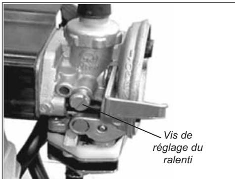
(1) Poser l'appareil sur le sol, puis démarrer le moteur et le laisser tourner au ralenti pendant 2 à 3 minutes jusqu'à ce qu'il soit chaud.
