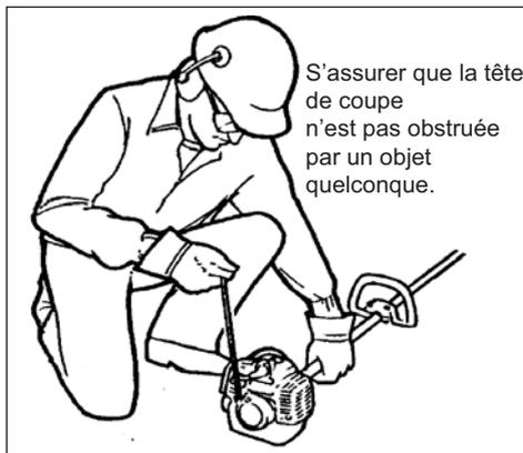
(d) En enfonçant le levier de blocage, tirer complètement le levier d'accélération et enfoncer le bouton de la gâchette de sécurité. En enfonçant le bouton de la gâchette de sécurité, relâcher le levier d'accélération et le levier de blocage. Le levier d'accélération reste à présent au ralenti (vitesse de démarrage).
