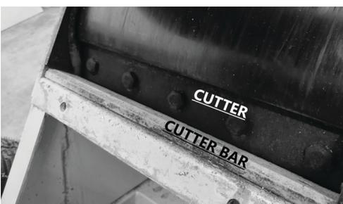
**Etape 6:** desserrer les vis de maintien du contre-couteau à l'aide d'une clé allen de 6 mm, juste assez pour lui permettre de bouger
