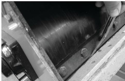
**Etape 8:** Resserrer deux vis et vérifier à nouveau l'écartement à l'aide d'une jauge d'épaisseur. Si l'ajustement est correct, resserrer les vis restantes. Dans le cas contraire, desserrer les deux vis et recommencer l'étape 7
