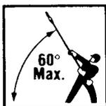
Ne pas incliner la machine à plus de 60° par rapport à l'horizontale, pour conserver une distance suffisante entre la branche à couper et l'utilisateur.
