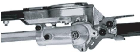
Les lames peuvent être réglées dans 11 positions différentes, allant d'un angle de 120° à 270° depuis le tube extérieur, comme indiqué. Toujours s'assurer que le levier de verrouillage est correctement bloqué après chaque réglage.
