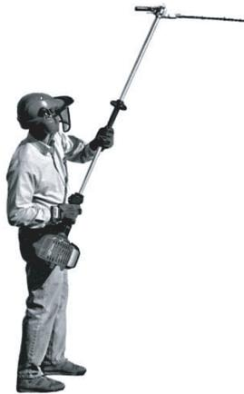
Actionner la gâchette d'accélérateur après le démarrage du moteur entraîne l'augmentation du régime moteur et le mouvement des lames. Régler le régime moteur en fonction de la quantité de haies à couper, par exemple.
