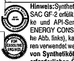
Hinweis: Synthetiköl, das die Norm IL-SAC GF-2 erfüllt und API-Zertifikatsmarke und API-Servicesymbol ab "SJ/CF ENERGY CONSERVING" aufweist (siehe Abb. links), kann bei allen Temperaturen verwendet werden. Die Verwendung von Synthetiköl ändert nichts an den erforderlichen Ölwechselintervallen.
