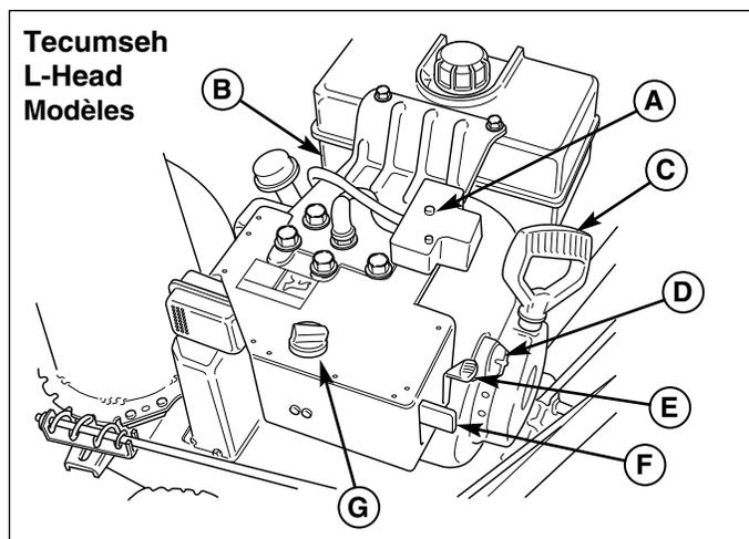
**Figure 5. Commandes du moteur**
