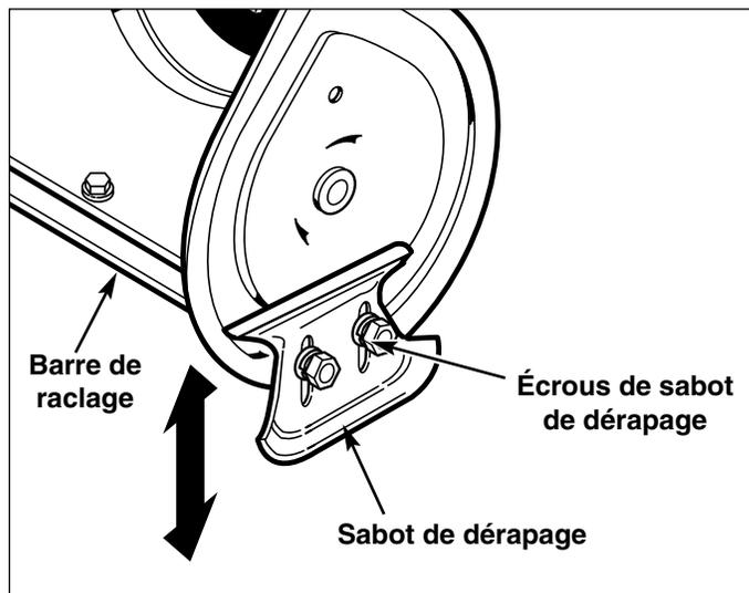
Figure 10. Réglage des sabots de dérapage
