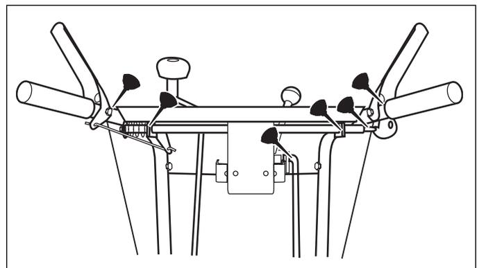
Figure 17. Lubrification de la commande Free Hand
