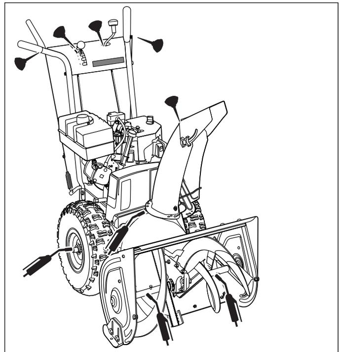
Figure 16. Principaux points de lubrification du chasse-neige
