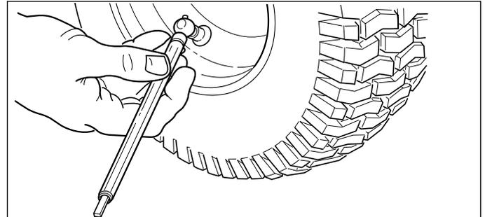
Figure 13. Vérification de la pression des pneus
