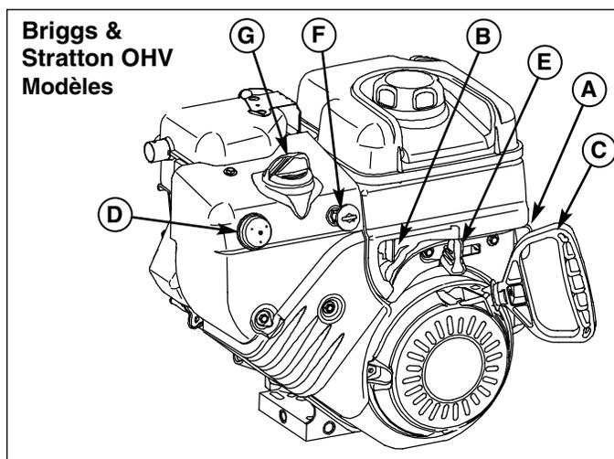
Figure 2. Commandes du moteur
