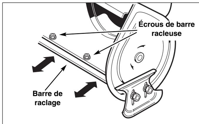
Figure 10a. Réglage de la barre racluse (modèles récents)
