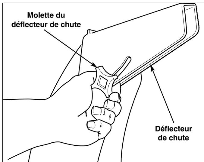
Figure 9. Réglage du déflecteur de chute
