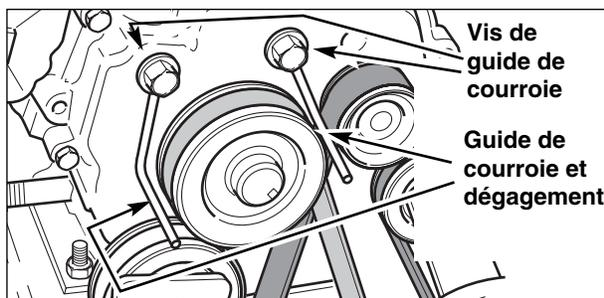
Figure 27a. Réglage du guide de courroie de la vis sans fin (modèles récents)
